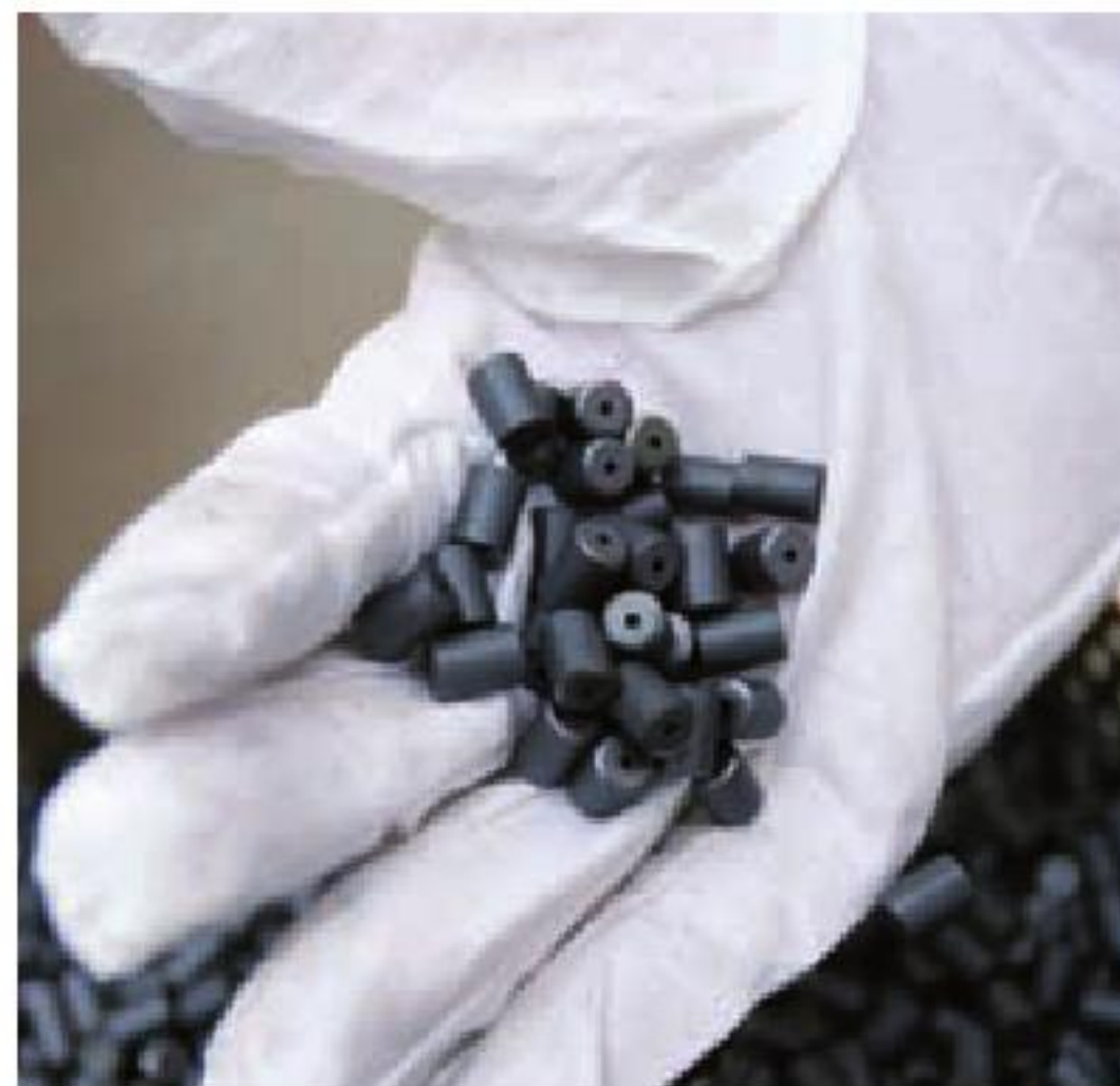
♦ Pellets de dióxido de uranio que se usan como combustible para los reactores nucleares.
